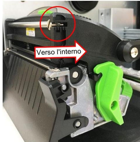
2. Se il regolatore della tensione del nastro è posizionata sul livello del lato più interno, ma non ha migliorato l'increspamento del nastro, girare il regolatore della pressione del nastro per 1 livello e stampare di nuovo l'etichetta per controllare se l'increspamento sparisce.
