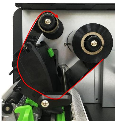
4. Infilare il nastro sotto la barra di guida del nastro attraverso la fessura del sensore del nastro, come il percorso di caricamento stampato sulla stampante.
