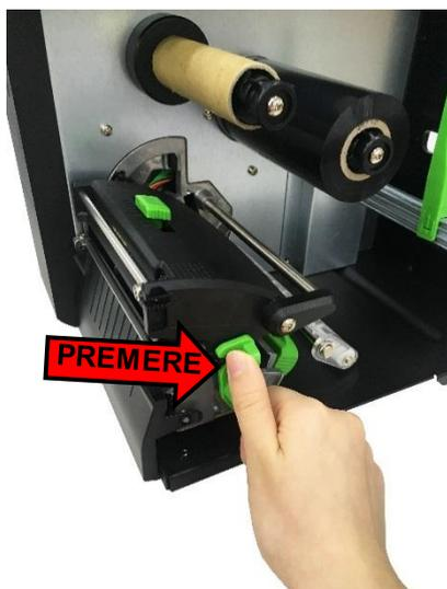
3. Spingere la leva di sblocco della testina per aprire il meccanismo della testina.
