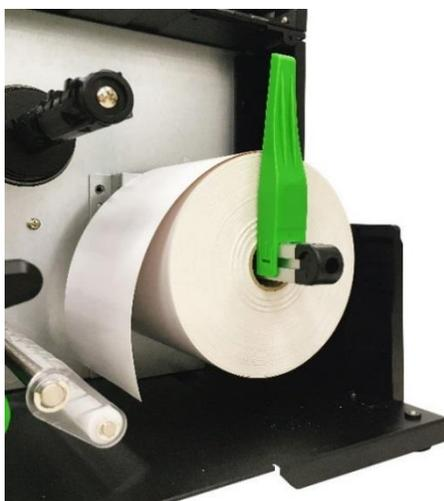
3. Collocare il rotolo del supporto sul mandrino di fornitura etichette e utilizzare la leva di protezione del rotolo per fissarlo.
