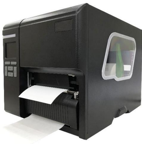
7. Chiudere la leva di sblocco della testina e il modulo per funzione adesiva. Quindi, chiudere il coperchio sulla destra della stampante.
