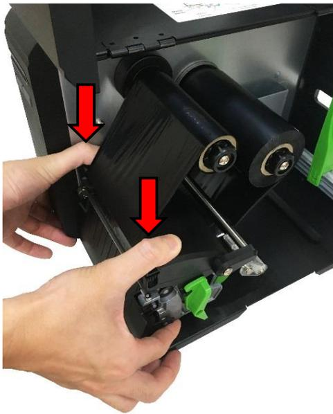
7. Chiudere il meccanismo della testina spingendo entrambi i lati della leva di sblocco della testina.
