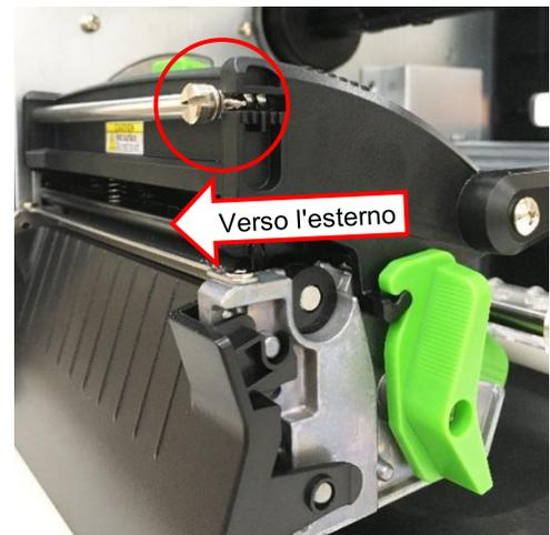
2. Se il regolatore della tensione del nastro è posizionata sul livello del lato più esterno, ma non ha migliorato l'increspamento del nastro, girare il regolatore della pressione del nastro per 1 livello e stampare di nuovo l'etichetta per controllare se l'increspamento sparisce.
