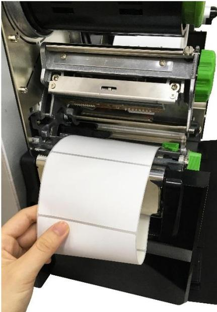
6. Aprire la leva di rilascio della testina di stampa e la leva di rilascio della barra di guida dell'etichetta per spingere circa 650 mm di etichette attraverso la parte anteriore della stampante.
