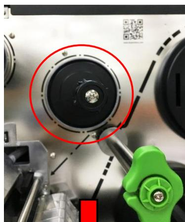
2. Installare il nastro sul perno d'alimentazione del nastro.
